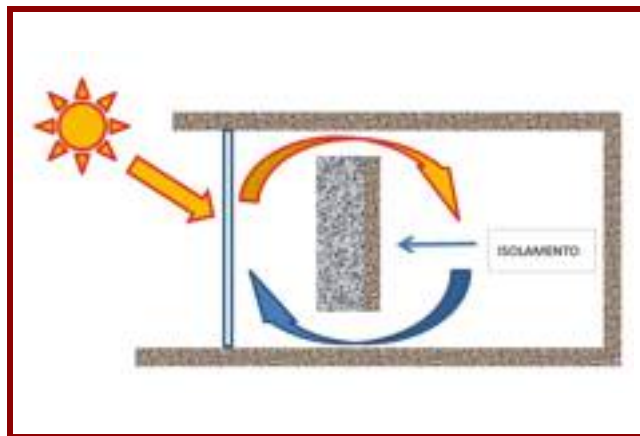
▲ Figura 2 - Muro ad accumulatore isolato
